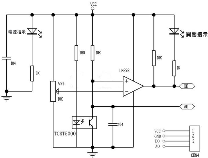
TCRT5000 傳感器的紅外發射二極管不斷發射紅外線，當發射出的紅外線沒有被反射回來或被反射回來但強度不夠大時，光敏三極管一直處於關斷狀態，此時模塊的輸出端為高電平，指示二極管一直處於熄滅狀態；被檢測物體出現在檢測範圍內時，紅外線被反射回來且強度足夠大，光敏三極管飽和，此時模塊的輸出端為低電平，指示二極管被點亮。
